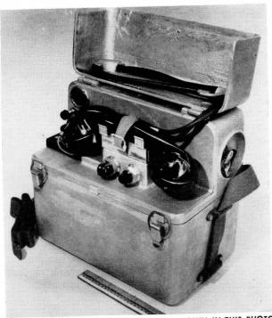
LOCATION OF OPERATING CONTROLS IS SHOWN IN THIS PHOTO OF THE TELEPHONE TP-9-( ).
