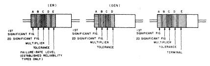
COLOR CODE MARKING FOR COMPOSITION TYPE RESISTORS.
