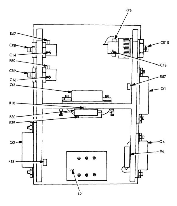
HEATSINK ASSEMBLY (COMPONENT SIDE)
