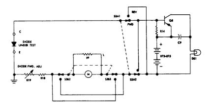
Figure 3-5. Diode Test
