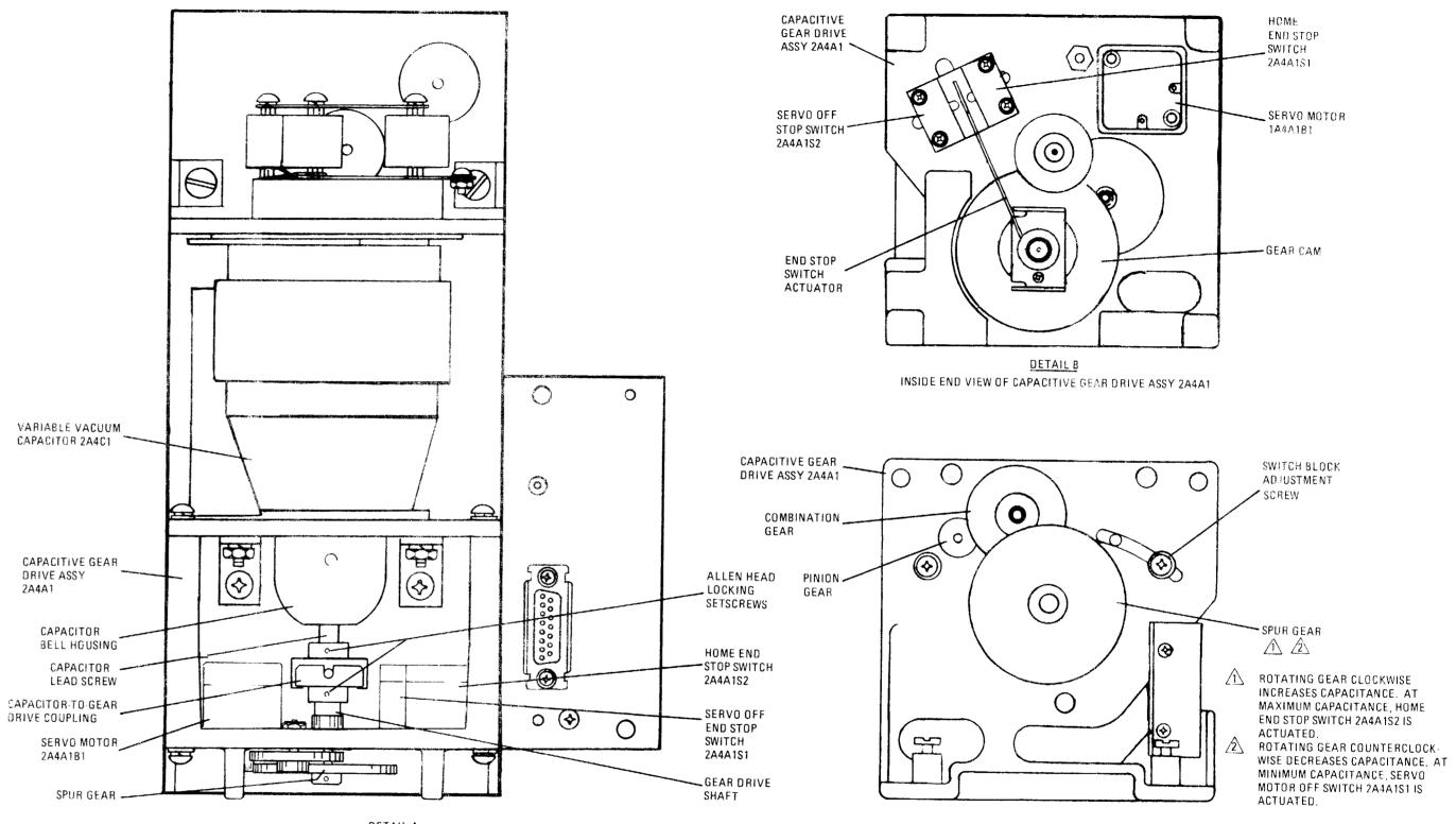
DETAIL A TOP VIEW OF CAPACITIVE GEAR DRIVE ASSY 2A4A1
