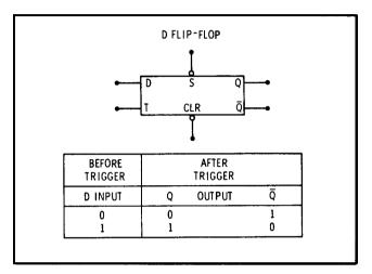
Figure 8-6. D Flip-Flop
