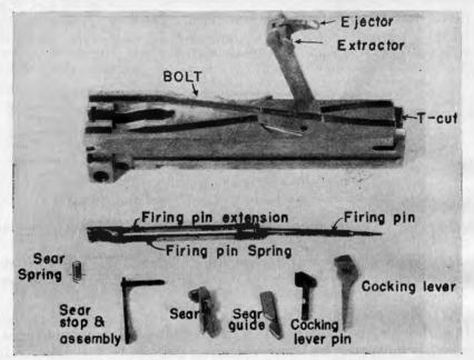
FIGURE 194 .- Bolt group, caliber .50 machine gun, M2.
