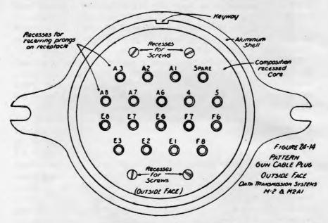
FIGURE 181 .- Pattern of gun cable plug.
